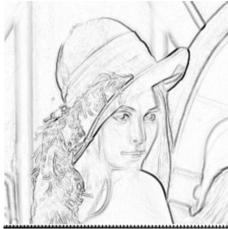
Fig. 8.7: Harta de intensitate a contururilor (modulul maxim al gradientului) calculat cu măști Prewitt pentru imaginea "lena".
